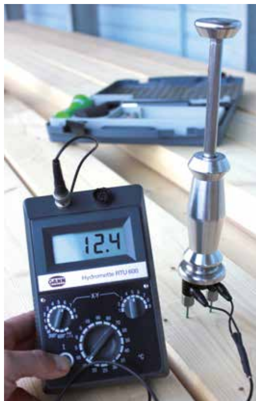
Abb. 2.2: Elektronische Holzfeuchtemessung
